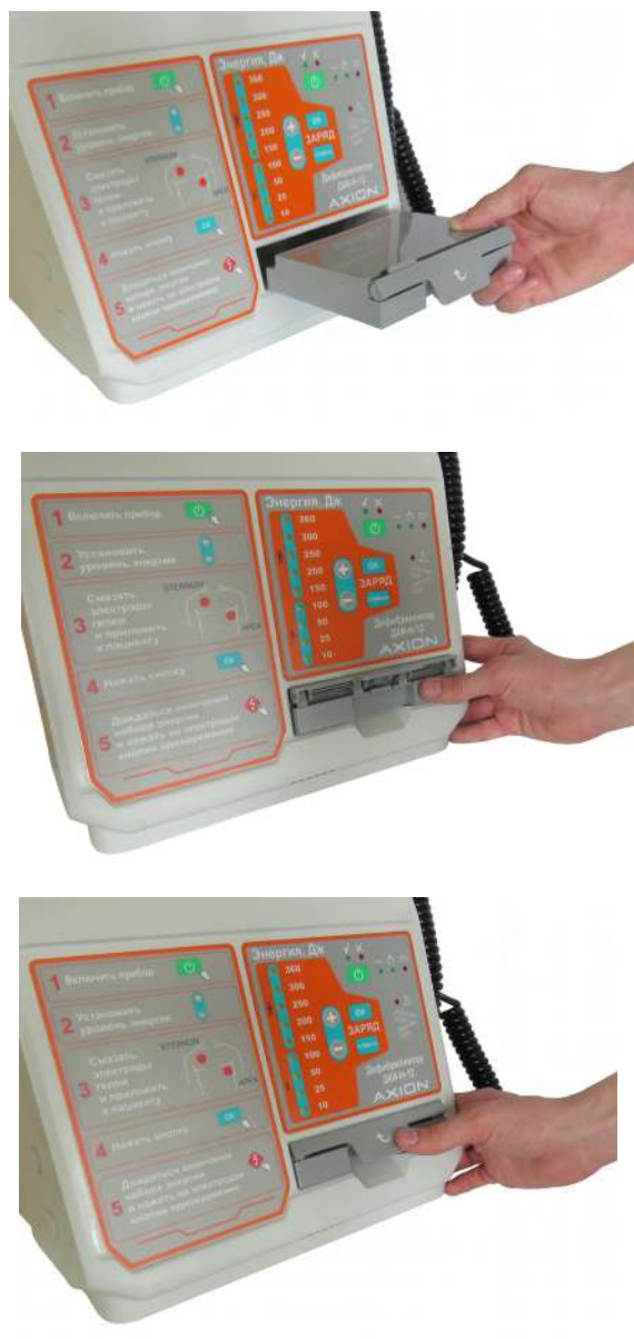
Рисунок 16 – Установка аккумуляторной батареи
